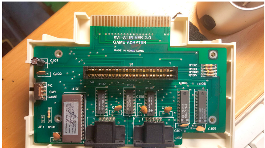
SVI-811B sisältä. Liittimien lisäksi myös ROM löytyy tältä piirilevyltä.
